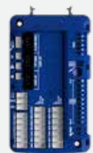
SIMÉO BOÎTIER MULTIPLEXAGE SYSTÈME DE COMMANDE ET SIGNALISATION DE LA BOÎTE À BOUTONS MULTIPLEXING UNIT CAR OPERATING PANEL MANAGEMENT AND SIGNALLING
